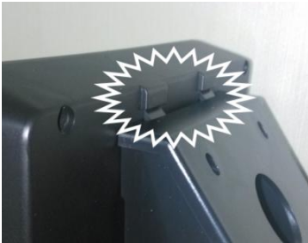
图 2：设备后壳对准挂板
