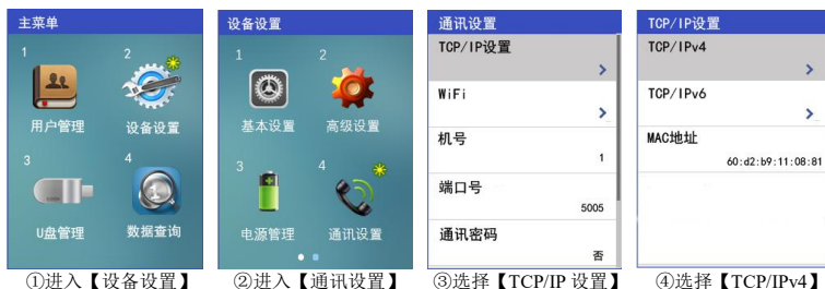
①进入【设备设置】 ②进入【通讯设置】 ③选择【TCP/IP设置】 ④选择【TCP/IPv4】
